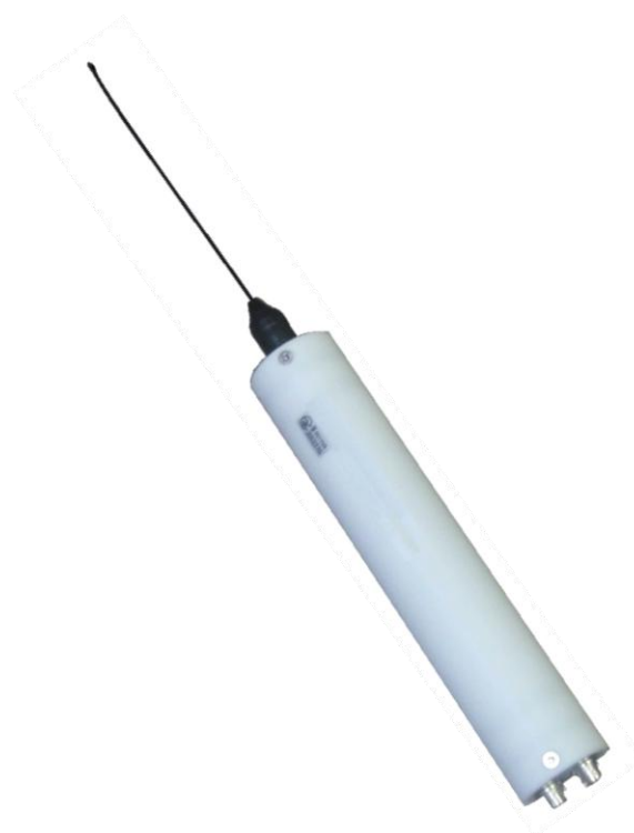
(送信機本体 φ40mm×L200mm、アンテナ 176mm)
