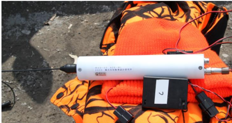
写真 1 : SS 特小送信機 (周波数 426MHz 帯、電波出力 1mW )
