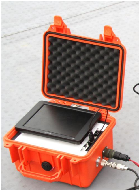
写真 2 : SS 特小受信装置 (SS 無線試験評価用)
